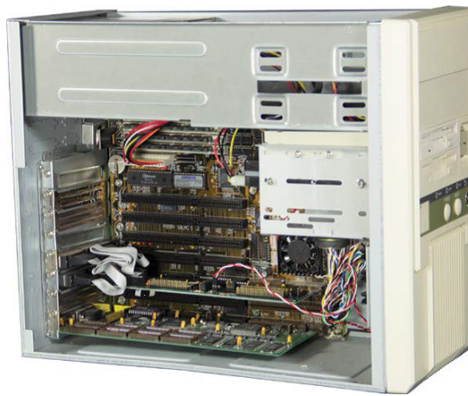
تصویر ۶۸: فضای داخلی یک رایانه شخصی سازگار با IBM از اواسط دهه ۱۹۹۰ که مفهوم معماری باز را نشان می‌دهد.
