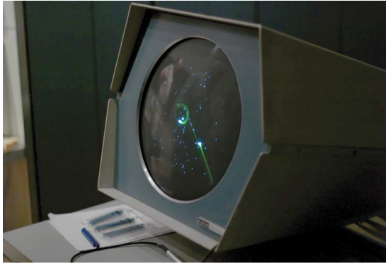
تصویر ۲۰: جنگ فضایی که روی یک کامپیوتر کوچک PDP-1 پخش می‌شود. ردپای سبز و زرد رنگ، نشان‌دهنده مسیر حرکت و شلیک سفینه‌هاست. (عکس از Joi Ito. CC BY 2.0)
